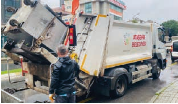
Ataçmanlı Yeraltı ve Yerüstü Konteyner Sistemlerinden Çöplerin Toplanması ve Taşınması
