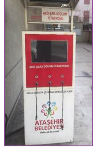
Akü Dolum İstasyonu
