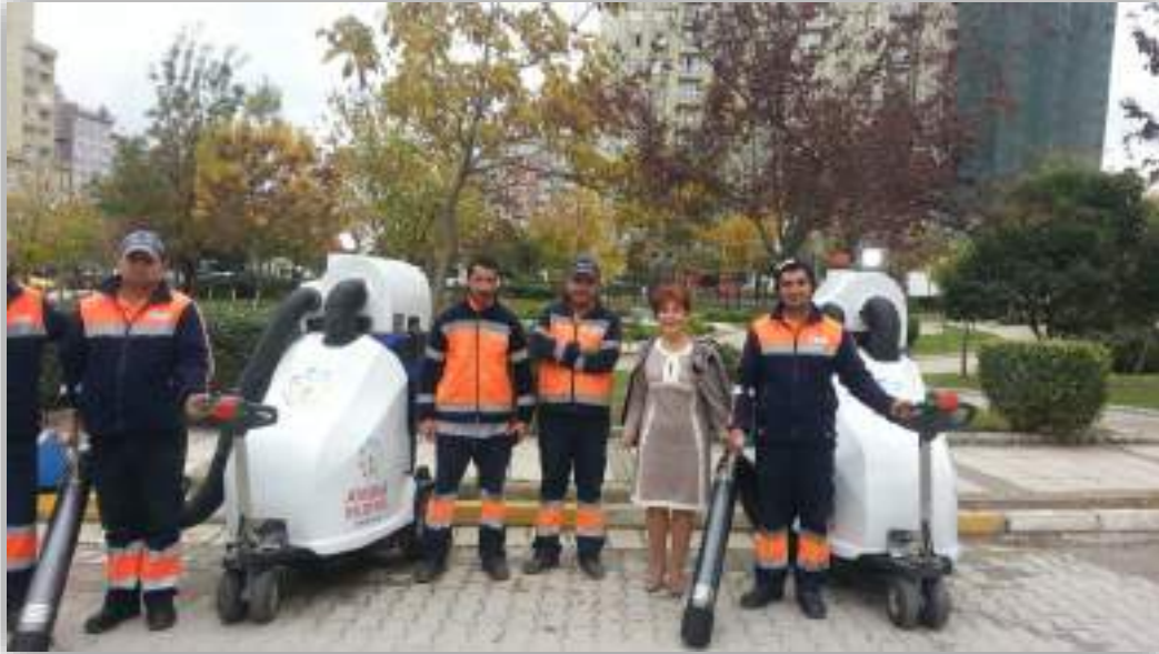
240 Litre Kapasiteli, Elle Kumandalı, Elektrikli Süpürme Makinesi
