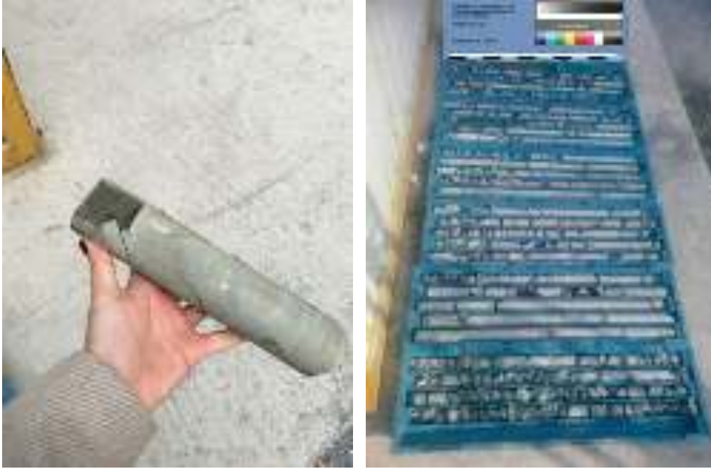
3387 Ada, 1 parsel sayılı yerde yapılan sondaj çalışmasında karot sandıklarına dizilen numunelerden (kumtaşları - çamurtaşları) örnek çalışma
