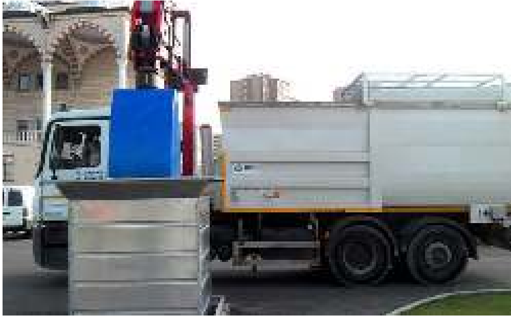
Yeraltı konteyner sistemi ile evsel atık toplama ve taşıma
