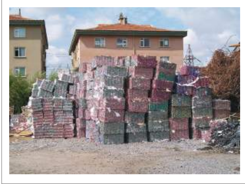
Kağıt Atıklar Elle Ayrıştırma İşleminin Sonra Preslenerek Sıkıştırılır ve Araca Yüklenecek Üzere Hazır Hale Getirilir.
